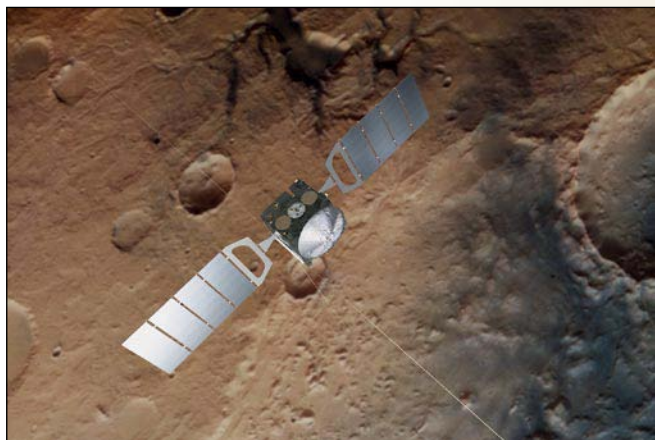
Космический аппарат Mars Express с двумя 20-метровыми радарными антеннами над Марсом.
